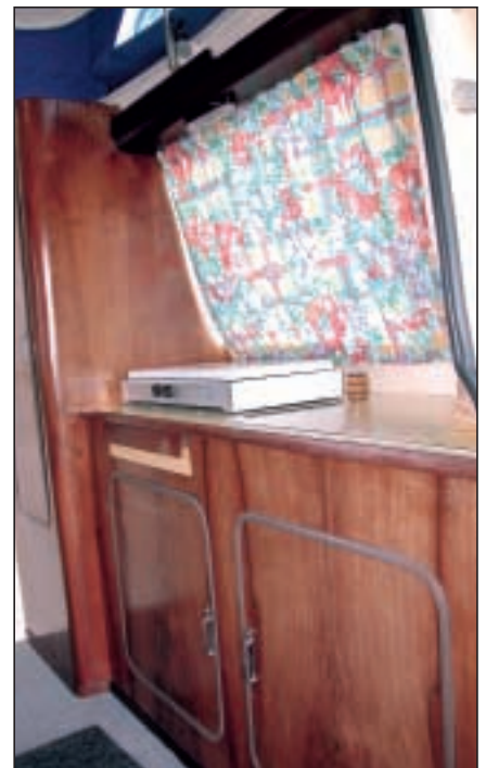
Kjøkkenbenk med franske kokebluss og overdekket utslagsvask: Kompakte mål. I hjørnet ved siden av benken står klesskapet.
