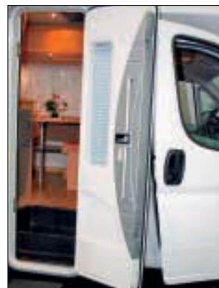
Ikke bra: Dørene på passasjerside og bodel slår i hverandre.
