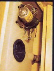
50 l. væntræk med elektrisk pumpe.
