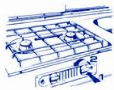
Gasherd mit Wärmesicherungen
